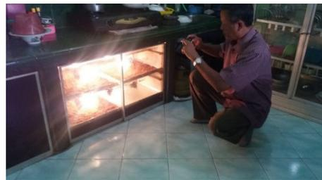
Gambar 2. Alat Pengeringan dengan lampu bolam
