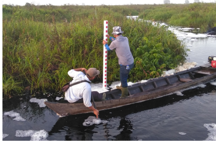
Gambar 11 Pemasangan alat pengamatan tinggi muka air gambut
