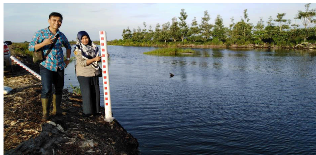
Gambar 8 Pipa paralon yang diberikan garis – garis penanda untuk melihat perubahan naik turunnya tinggi muka air
