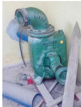
Gambar 2 Pompa Air Sentrifugal
