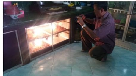
Gambar 2. Alat Pengeringan dengan lampu bolam
