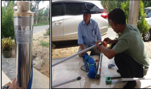
Gambar 7 Bentuk Fisik Pompa Celup dan Proses Perakitannya
